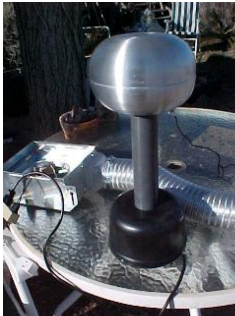
Van de Graaf Generator, 200k Volts
